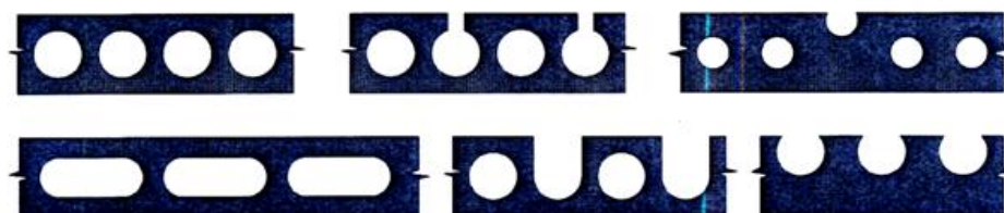
А.47-сурет – Тесік жолақтар түріндегі қосқыш элементтер [20]
